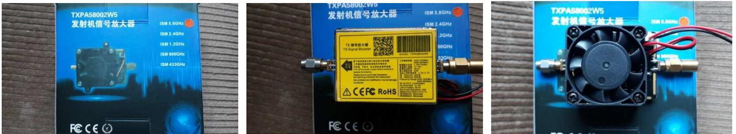
Les modifications effectuées, SMA changée et atténuateur en entrée remplacé par une résistance de zéro ohm en 0603 ou 0402.
